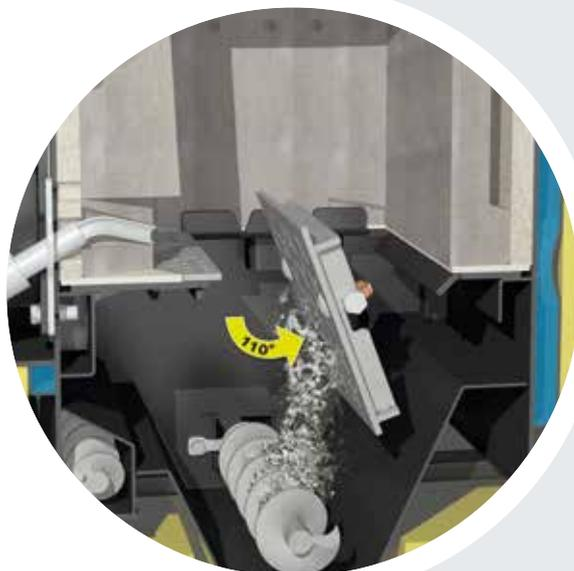
Grâce à son inclinaison de 110°, les cendres tombent entièrement de la grille basculante et sont transportées dans le grand cendrier mobile au moyen de la vis de déchargement.
