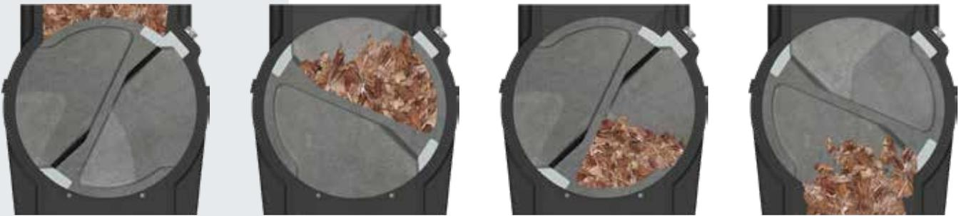
Les deux chambres de grand volume (diamètre du rotor : 200 mm) sont parfaitement adaptées au bois déchiqueté jusqu'à P31S (anciennement G50). L'écluse détecte immédiatement toute résistance plus importante. Dans ce cas, l'écluse rotative et la vis sans fin fonctionnent en marche arrière (plusieurs fois, en fonction des paramètres réglés) jusqu'à ce qu'il soit possible de poursuivre le transport du combustible.
